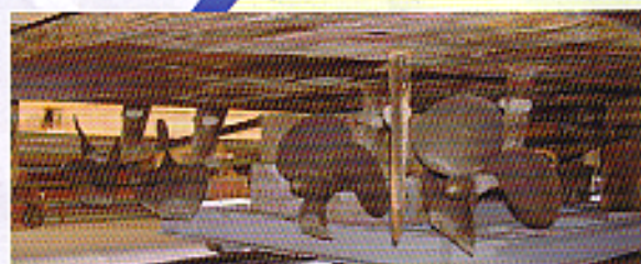
推進器(三翼固定ピッチプロペラ) 4基 4基のエンジンと長いシャフトで直結された特殊構造
